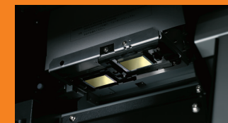
Cabeça de impressão dupla em formação escalonada.
